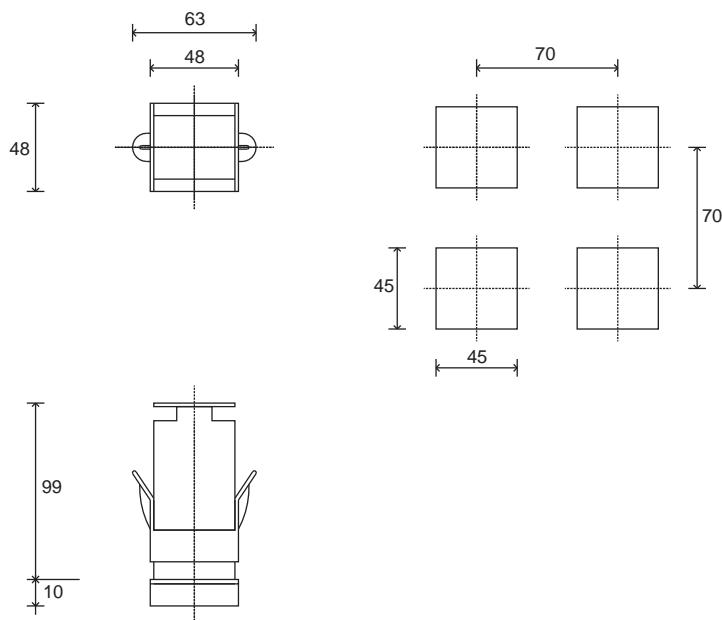
Размеры: 48x48mm (1/16 DIN) с глубиной 99мм
