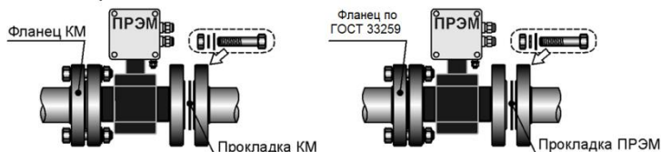
Рисунок 19 – Варианты монтажа ПРЭМ фланцевого исполнения
