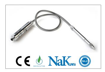
ILK - модель высокотемпературных датчиков давления с NaK наполнением и цифровым выходом. Модель ILK с интерфейсом "IO-Link" является интеллектуальным устройством, соответствующим требованиям среды "Industry 4.0" с дополнительной информацией, предотвращающей простой машины, и благодаря решению "без ртути" работает с температурой процесса вплоть до 538°C.
