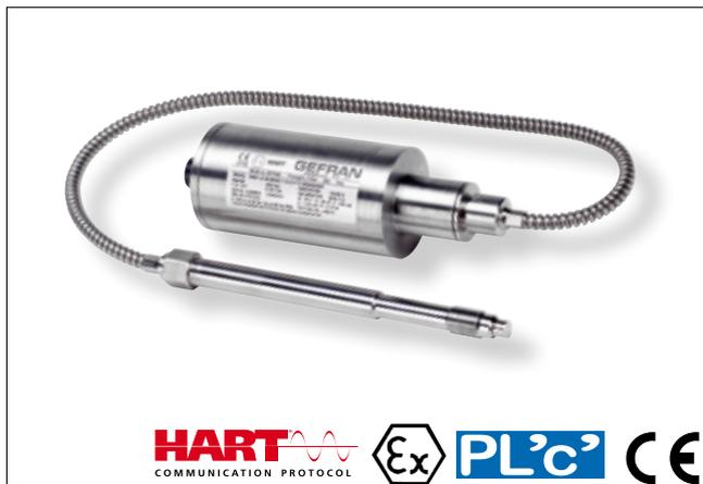
Модель Gefran HMX - это датчики давления с протоколом связи HART для использования в высокотемпературной среде со взрывоопасной атмосферой. Главной характеристикой этой модели является возможность работы при температуре до 400°C. Конструктивный принцип основан на гидравлической передаче давления. Заполненная жидкостью система обеспечивает температурную стабильность. Физическая мера преобразуется в электрическую меру с помощью тензометрической технологии.
