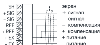
6-ти проводный кабель с 4-х проводным тензодатчиком
