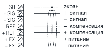
6-ти проводный кабель с 6-ти проводным тензодатчиком
