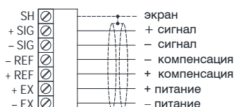
6-ти проводный кабель с 6-ти проводным тензодатчиком
