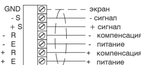
6-ПРОВОДНЫЙ КАБЕЛЬНЫЙ ВЫХОД С 6-ПРОВОДНЫМ ТЕНЗОДАТЧИКОМ ВЕСА
