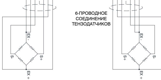
4-ПРОВОДНОЕ СОЕДИНЕНИЕ ТЕНЗОДАТЧИКОВ
