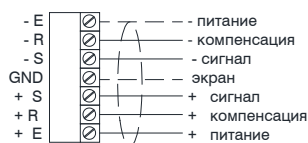
6-ПРОВОДНЫЙ КАБЕЛЬНЫЙ ВЫХОД С 6-ПРОВОДНЫМ ТЕНЗОДАТЧИКОМ
