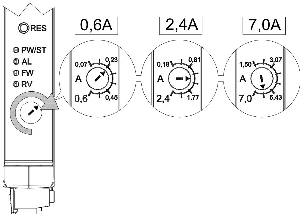
После завершения движения поворотного селектора светодиод PW/ST мигнет СИНИМ цветом количество раз, равное номеру выбранной позиции, чтобы подтвердить выбор номинала двигателя. Калибровка также возможна при работающем двигателе. Нажав кнопку RES на передней панели более чем на 3 секунды, можно проверить калибровку по миганию светодиода PW/ST.
